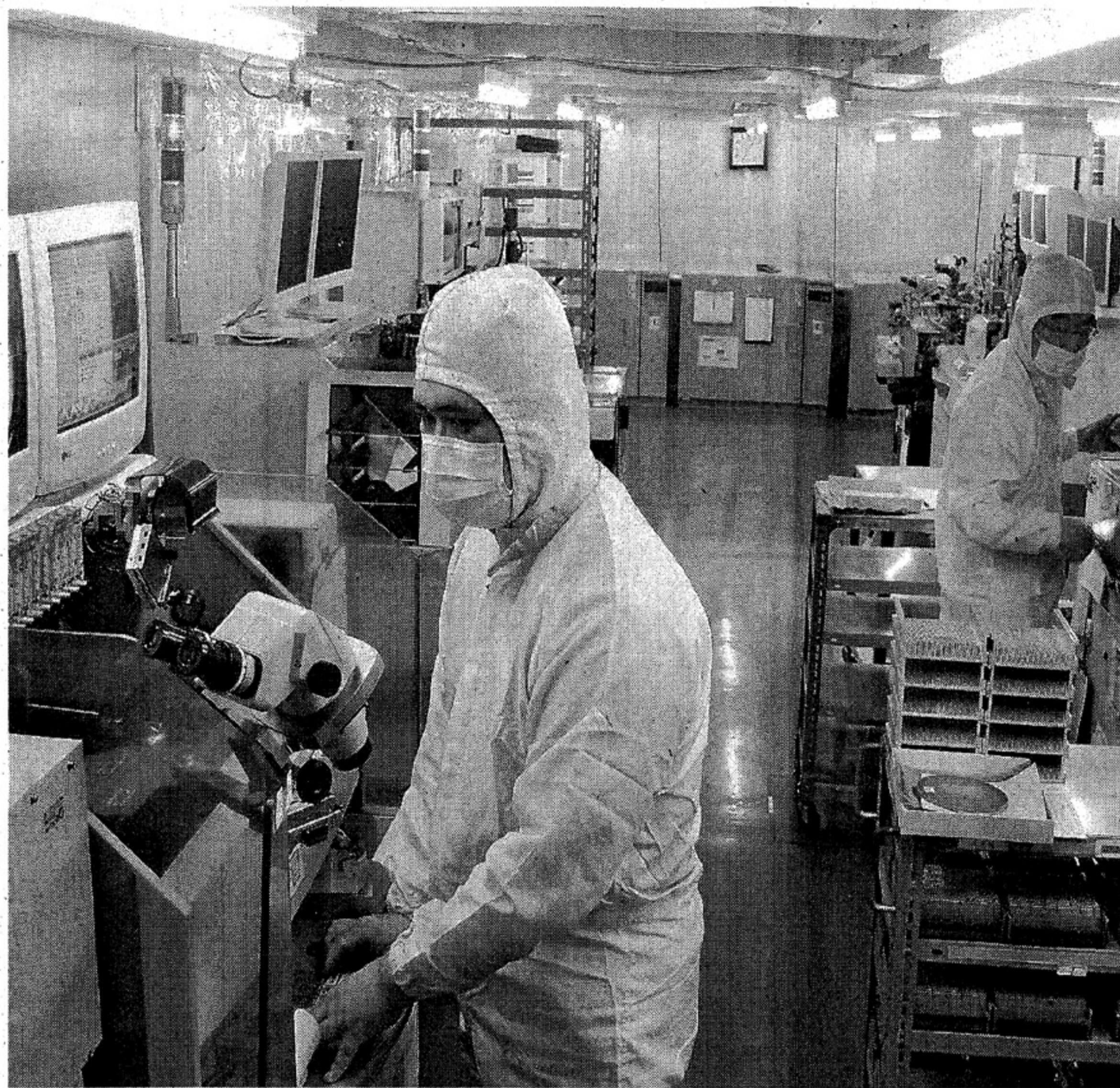
砲弾型LED部品を製造する作業場。トリコンの心臓部だ=島根県邑南町
