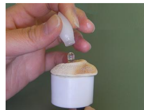
図4-4. 炎型キャップをLEDランプにかぶせる
