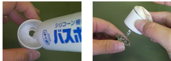
図4-3. 本体ケースに基板を接着
