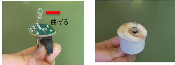
図4-2. 本体ケースの穴にLEDランプを合わせる
